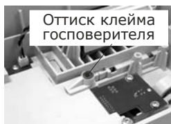
Рис. 1.2– Места пломбирования вычислителя
