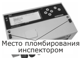
Рис. 1.2– Места пломбирования вычислителя
